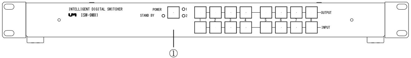
①のスイッチを長押しすることで電源ON（緑色点灯）スタンバイLED消灯
