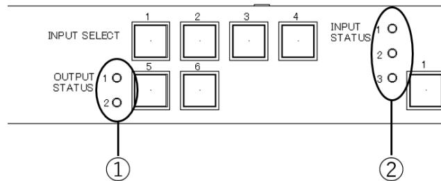
① HDMI OUTに接続されるシンク機器との状態を表示します。
