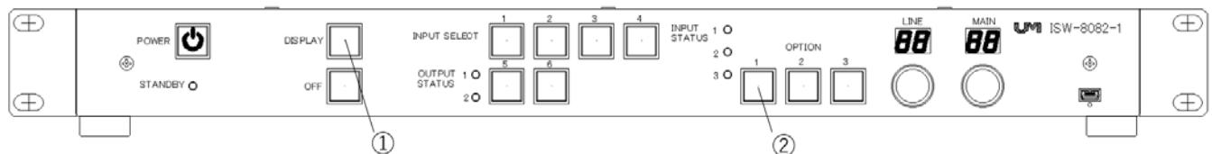
①DISPLAYスイッチON時に、外部接続機器が正常に制御できない場合エラーメッセージを表示します。
