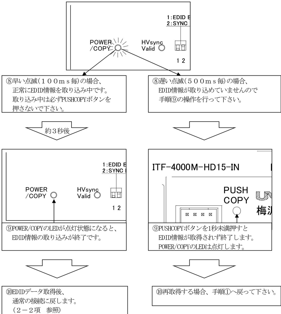
※設定したEDIDを使用する場合は、EDID取得用スイッチを“↓ON”にしてPCを起動させます。すでにPCを起動している場合は再起動してください。起動すると現在の接続をPCが認識し、ディスプレイに情報を出力します。
